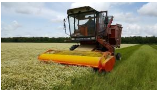
Слика 2. Комбајн адаптиран за брање цвета камилице
