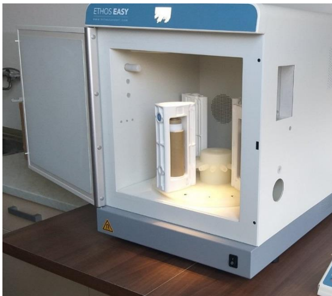
Слика 13.3. Припрема узорака у микроталасном дигестору Ethnos Easy – T480 за Копаоник, Црни врх и Мокру гору у лабораторији Института за шумарство, Београд
