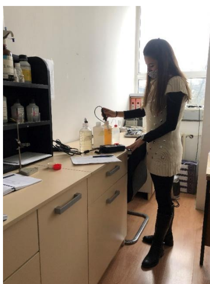
Слика 14.13.-14.14. Одређивање кондуктивитета и рН вредности у референтним узорцима за тест оспособљености и узорцима депозиције Figure 14.13.-14.14. Determination of conductivity and pH values in referent aptitude test samples and deposition samples
