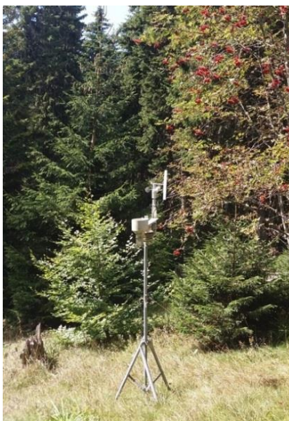
Слика 20.2. Метеоролошка станица за аутоматска мерења микроклиматских услова, Огледно поље Ниво-а 2, Копаоник
