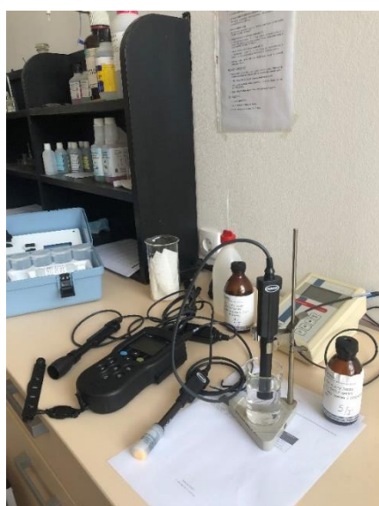
Слика 14.13.-14.14. Одређивање кондуктивитета и рН вредности у референтним узорцима за тест оспособљености и узорцима депозиције Figure 14.13.-14.14. Determination of conductivity and pH values in referent aptitude test samples and deposition samples
