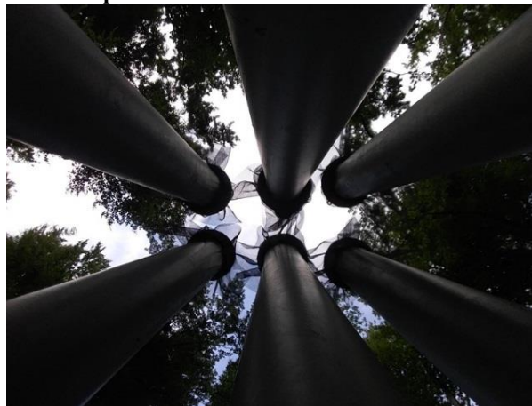
Слика 14.9-14.10. Постављање „Bulk“ колектора за влажну депозицију на отвореној површини Figure 14.9-14.10. Installation of "Bulk" collectors for wet deposition in the open field
