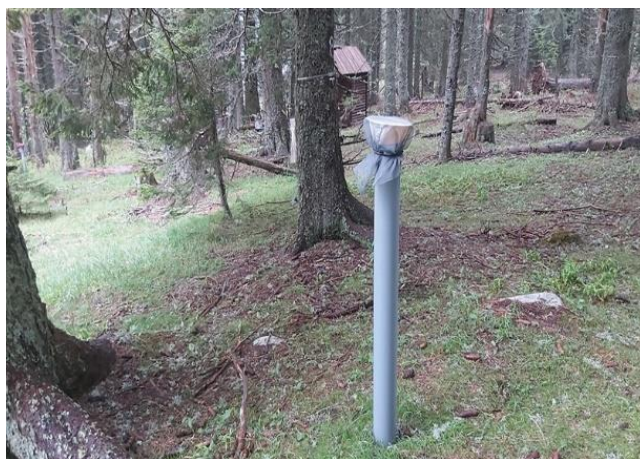
Слика 14.1. „Throughfall“ колектор на огледном пољу, БИТ Ниво 2, Мокра гора, 2020. година Figure 14.1. “Throughfall” collector on the observation plot of the Level II SP, Mokra Gora, 2020
