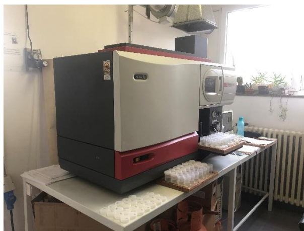
Слика 14.15-14.16. Одређивање концентрације елемената од интереса у припремљеним узорцима депозиције на ICP-OES спектрометру
