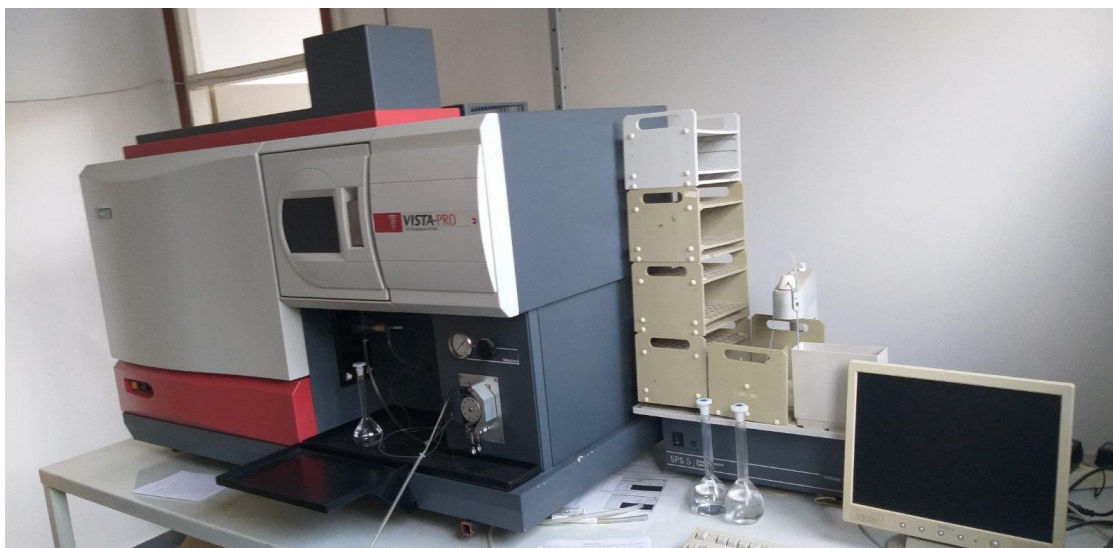
Слика 13.4. Одређивање количине хранљивих материја у лисном опаду (биланс кружења хранљивих материја у екосистему) за Копаоник, Црни Врх и Мокру Гору ICP – AES Spectrometer у лабораторији Института за шумарство, Београд Figure 13.4. Determination of the amount of nutrients in the litterfall (balance of nutrient cycling in the ecosystem) on Кораоник, Crni Vrh and Mokra Gora ICP – AES Spectrometer in the Institute of Forestry Lab, Belgrade
