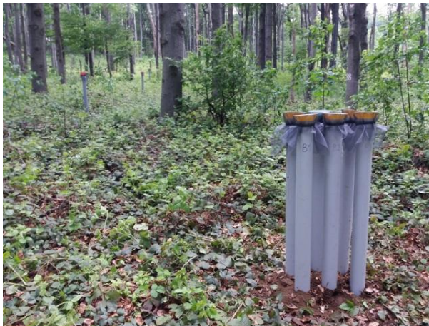
Слика 14.9-14.10. Постављање „Bulk“ колектора за влажну депозицију на отвореној површини Figure 14.9-14.10. Installation of "Bulk" collectors for wet deposition in the open field
