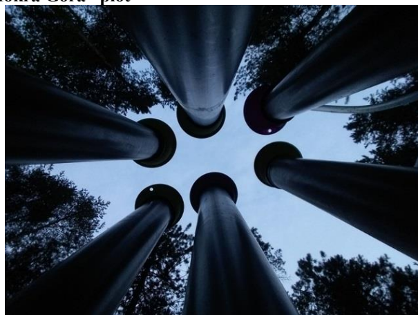
Слика 14.11-14.12. Постављање „Bulk“ колектора за влажну депозицију на отвореној површини Figure 14.11-14.12. Installation of "Bulk" collectors for wet deposition in the open field
